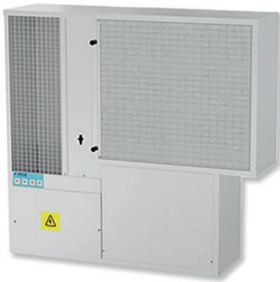
Deumidificatore isotermico studiato e dimensionato per il controllo dell'umidità relativa ambiente nei sistemi di raffrescamento radiante a pavimento/soffitto/parete. È costituito da una unità frigorifera completa e corredato di batterie di pre-trattamento e post-trattamento alimentate con l'acqua refrigerata utilizzata nel sistema radiante.
